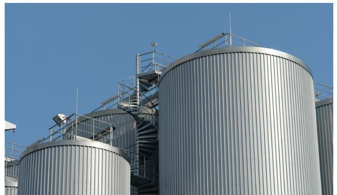
Abbildung 2: ...haben zylindrokonische Tanks den Vorteil, dass das Risiko einer Kontamination fast auf null sinkt.
