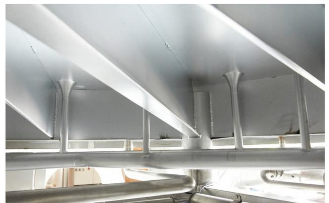
Fig. 4: Debido al desacoplamiento, el área de recolección se aumenta hasta 2,5 m<sup>2</sup> con la actual distancia del falso fondo y el diseño optimizado del tulipán de recolección, sin tener que comprometer la velocidad de filtración, el rendimiento o la calidad del mosto.
