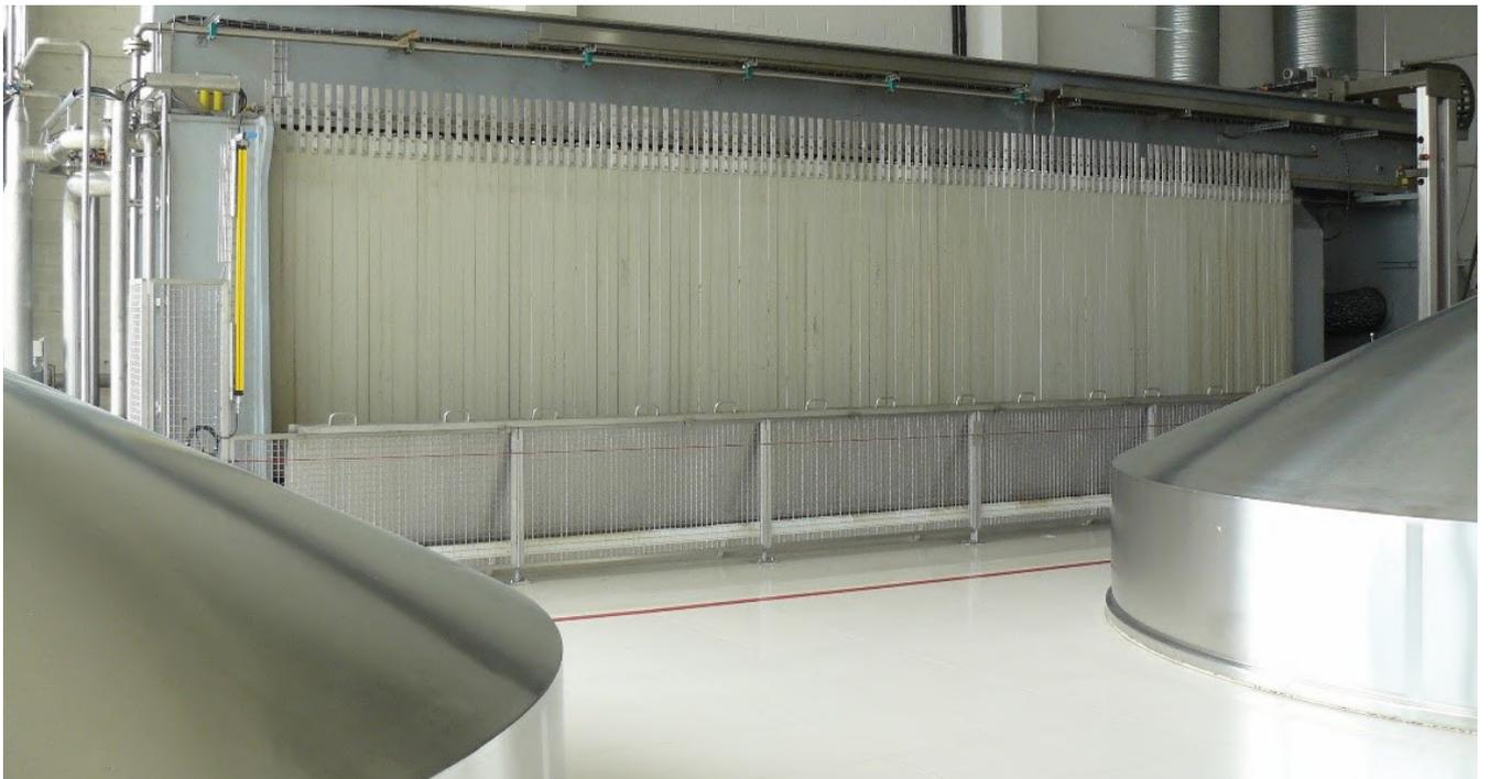
Fig. 5: En el filtro prensa, el afrecho total se divide en muchas tortas perpendiculares.
