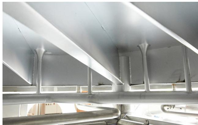
Abbildung 4: Aufgrund der Entkopplung ist die Quellgebietsfläche beim aktuellen Senkbodenabstand und strömungsoptimierter Tulpenform bis auf 2,5 m<sup>2</sup> anzuheben - ohne bei der Läutergeschwindigkeit, der Ausbeute oder der Würzequalität Abstriche in Kauf nehmen zu müssen.
