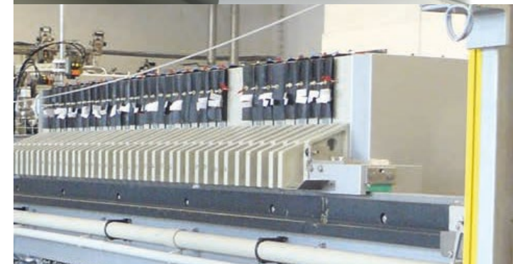
Filtración de alta velocidad
