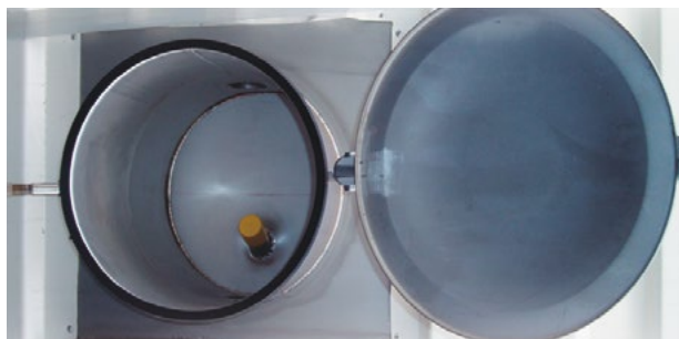
Temperatur-Messfühler im Kasten
